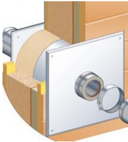
Figure 4-a : Traversée de mur
