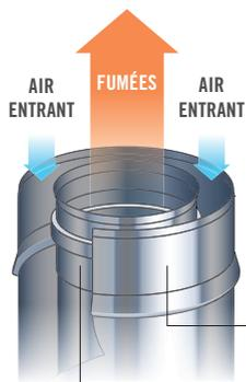
**LE CONDUIT CONCENTRIQUE** (avec deux tubes l'un dans l'autre) permet l'arrivée d'air comburant et l'évacuation des fumées **dans un même conduit.**
